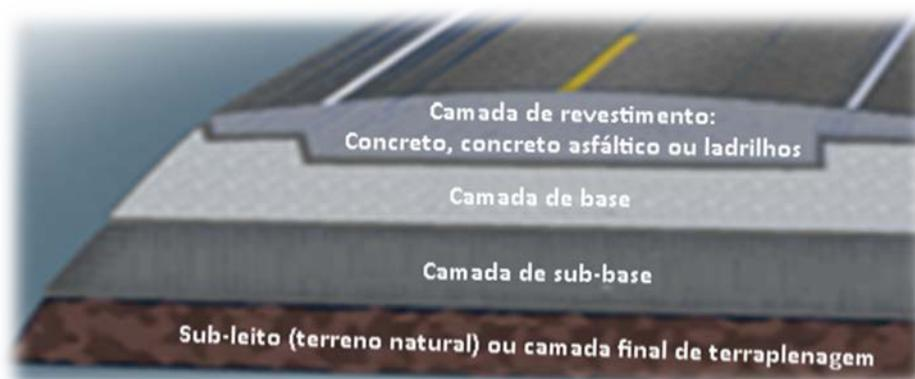
Figura 2-1 – Estrutura típica dos pavimentos
