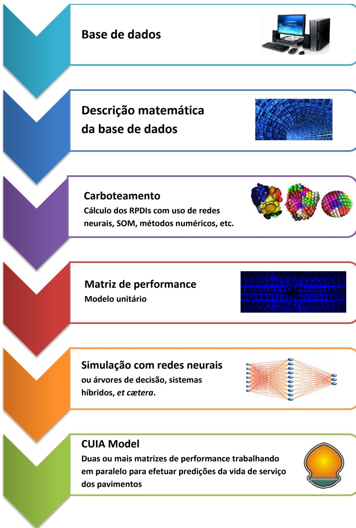
Figura 4-2 – Diagrama geral de funcionamento do método INTELLIPave
